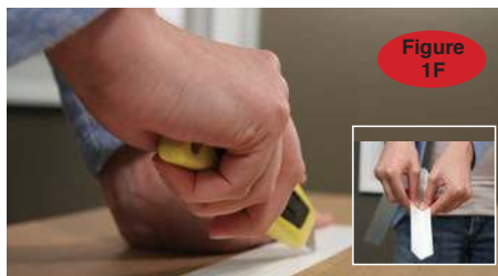
1F Si nécessaire, tailler et enlever des morceaux de la rallonge Miracle Fit selon la largeur désirée pour que l'écart entre le mur et le store à enrouleur soit bloqué. Et couper la rallonge Miracle Fit à la hauteur désirée tel que montré à la Figure 1A (de A à B).
